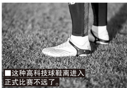
■Playermaker 的运动传感器通过耐用硅胶绑带固定在双脚球鞋的防滑钉上。
